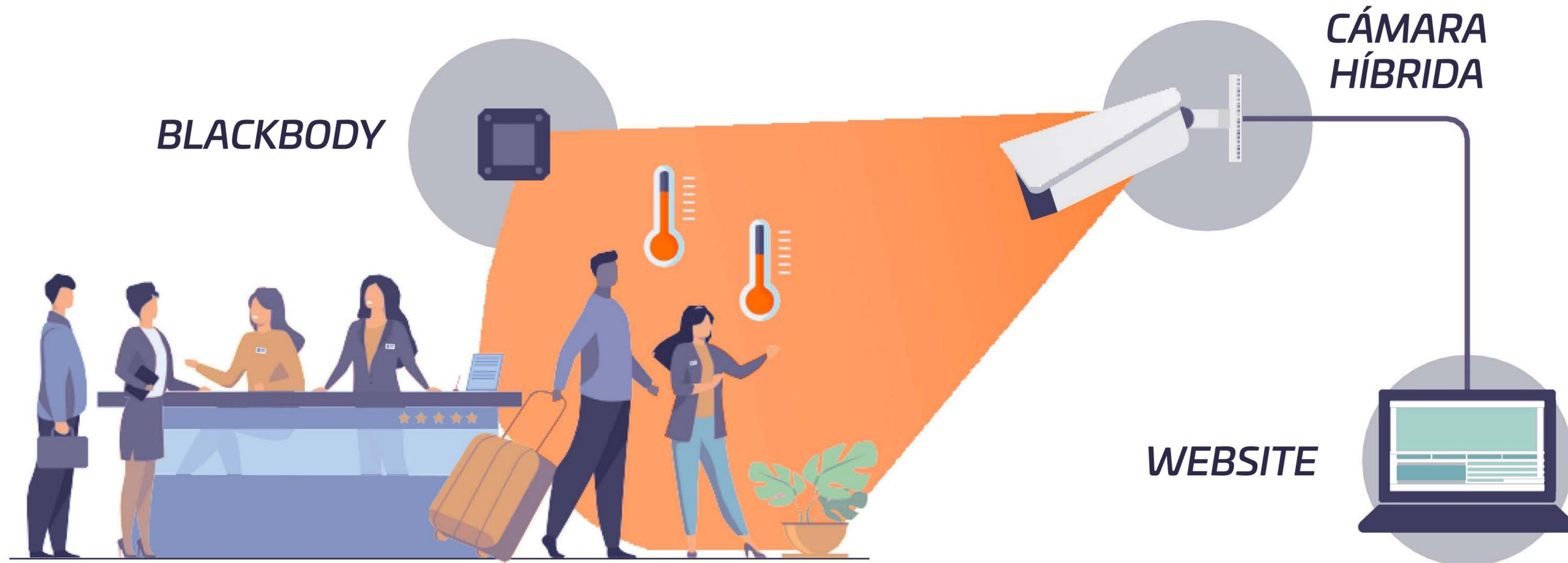
Visualización en tiempo real de las temperaturas medidas a través de la interfaz web de la cámara. El operador actúa en consecuencia permitiendo la comunicación bidireccional con el micrófono y los altavoces a bordo de la cámara para separar a aquellos en riesgo de la multitud. Por encima de un umbral determinado, se puede activar el LED blanco y / o un mensaje de audio de los altavoces.
